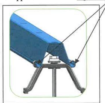
Le rail est équipé de perçages dans lesquels sont clipsées les butées de calepinage qui sont en Polypropylène 30% Fibré verre avec traitement anti UV
