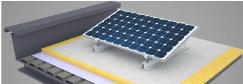
Figure 1 – Vue d'ensemble du procédé ROOF SOLAR – Cas de la configuration simple shed sur élément porteur en bac acier.
