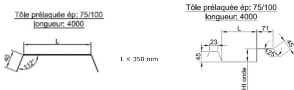
Tôle de raccordement sur TAN
