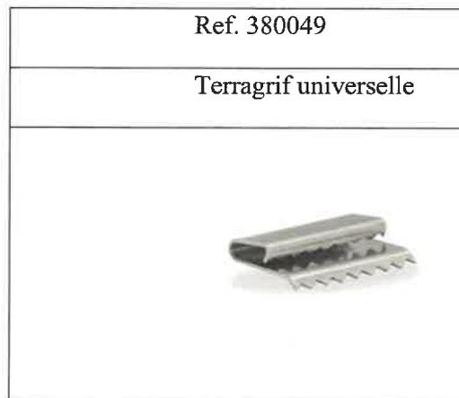
Cet élément permet d'effectuer la liaison équipotentielle des masses entre le cadre des modules photovoltaïques et les rails support. Il vient s'insérer dans le retour de cadre du module, et vient griffer le rail lors du bridage par les étriers.
