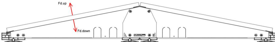
Les composantes horizontales des forces perpendiculaires (F) sont utilisées pour la détermination de la résistance au glissement du système.
