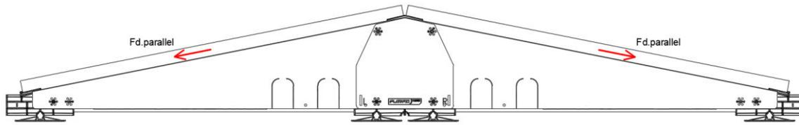
Les composantes horizontales des forces parallèles (F) sont utilisées pour la détermination de la résistance au glissement du système.
