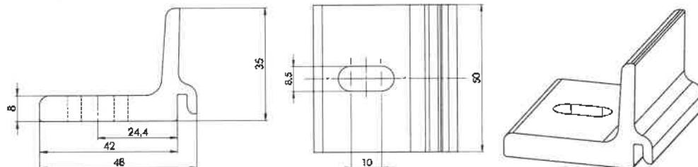
**La nouvelle version :** laquelle est subdivisée en plusieurs versions de Climbers selon le diamètre de la vis (36/50 RoofHook avec diamètre M8 – 36/50 avec diamètre M10 et 36/50 avec diamètre M12)
