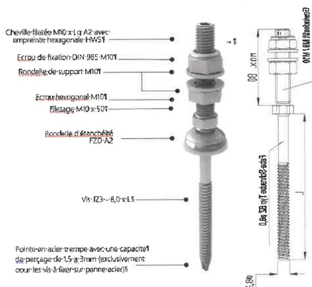
La vis de fixation panneaux solaires est disponible en différentes longueurs et différents diamètres. Elle est adaptée pour les toitures en fibrociment à profil ondulé et ossature porteuse en acier (S235). L'étanchéité de la couverture est assurée, selon la vis utilisée, soit par un joint FZD (références 2003013 à 2003017), soit par une calotte E16 (références 2003018 à 2003021).
