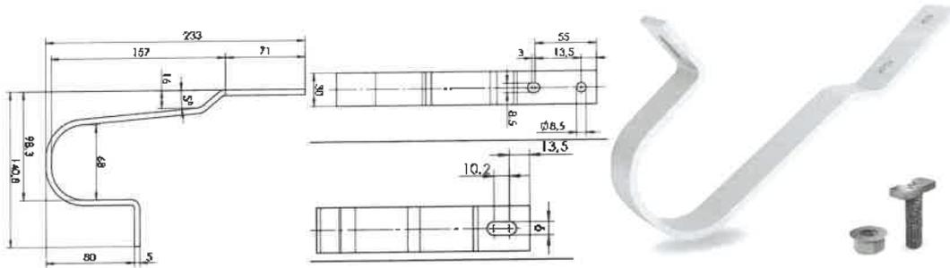
Crochet en acier inoxydable pour la fixation du SingleRail sur tuiles plates. Y compris vis à tête marteau (acier inox A2) et écrous à embase avec cran d'arrêt (acier inox A2) - Matériau : Acier Inox
