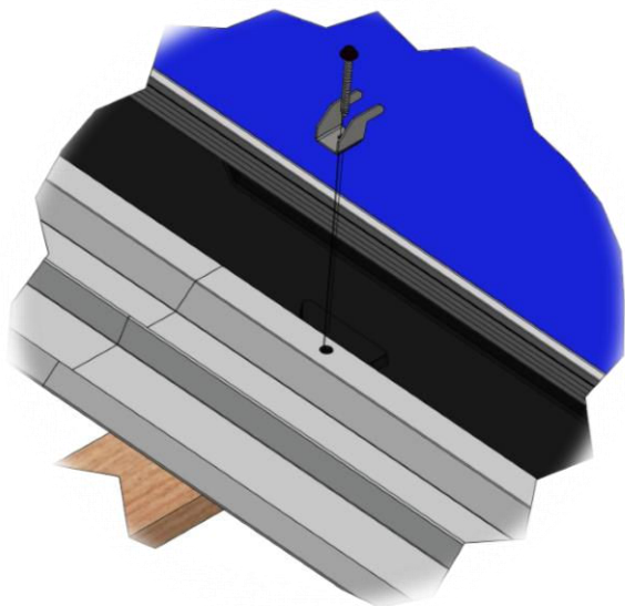
A : Dévisser l'ancien étrier, retirer le module et retirer la cale sous-jacente
