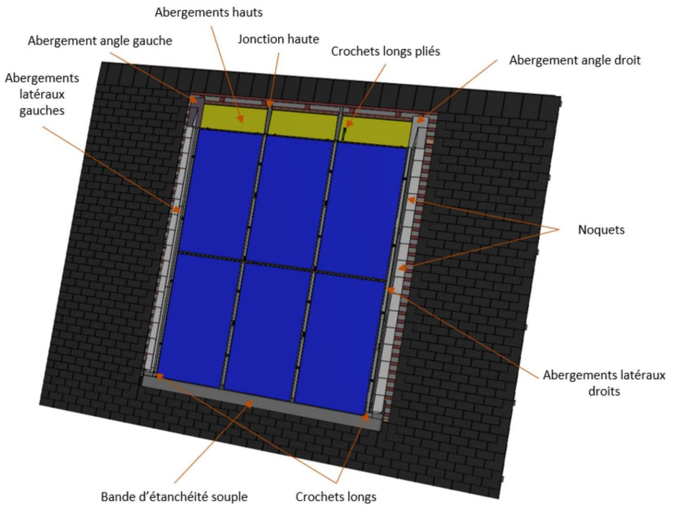
**Figure 33 – Éléments du kit A-2 mis en œuvre**
