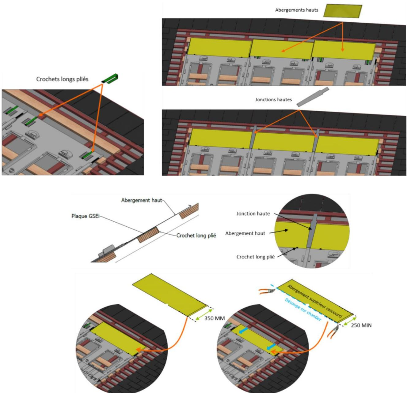
**Figure 30 – Pose des abergements supérieurs (kit A-2)**
