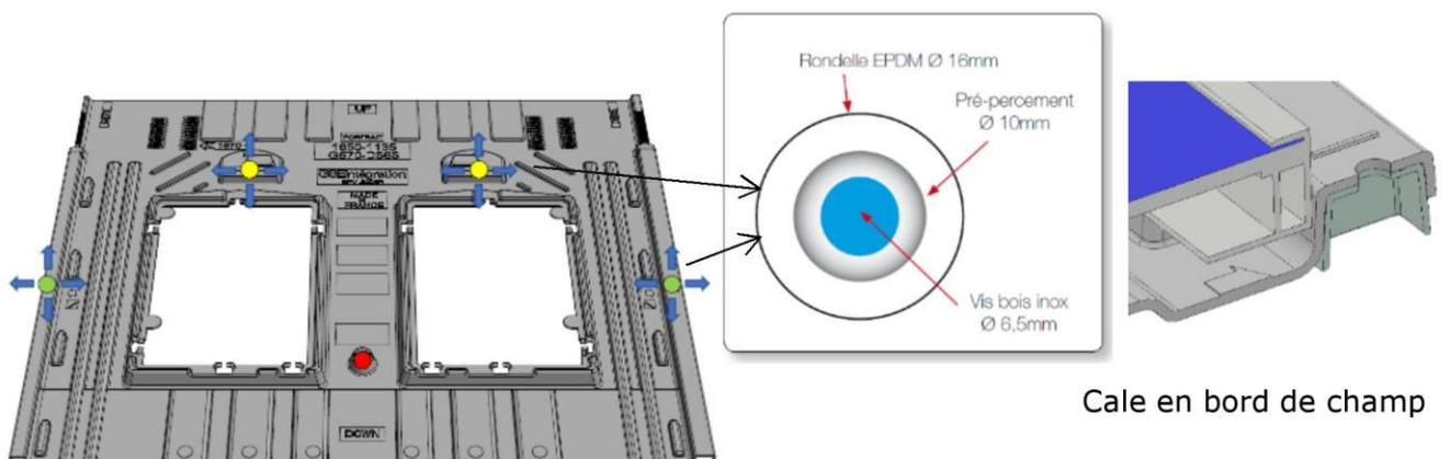
**Figure 18 – Pose de plaques polypropylène**
