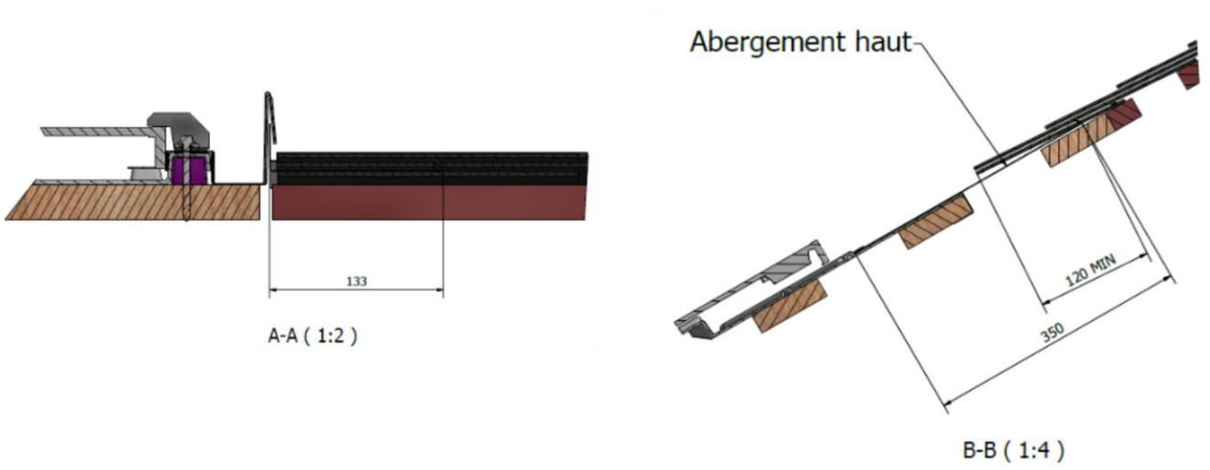
**Figure 32 – Mise en place des éléments de couverture (kit A-2)**
