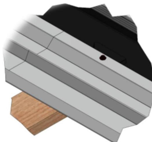
B : Visser une vis CAPINOX à l'endroit de l'ancien perçage en ayant préalablement placé une nouvelle cale en bois (ou en polypropylène s'il s'agit du bord de champ) sous l'onde
