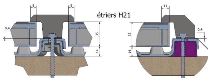
**Figure 20 bis –Chaines de cotes de l'écrasement du joint EPDM sous les étriers (suite)**
