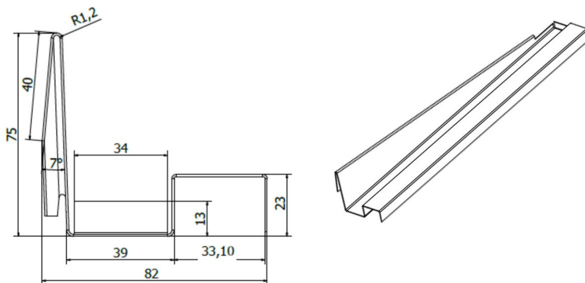
SUPPORT TUILES ET FEUILLARD : identique à celui du kit TS-2, cf. Figure 7
