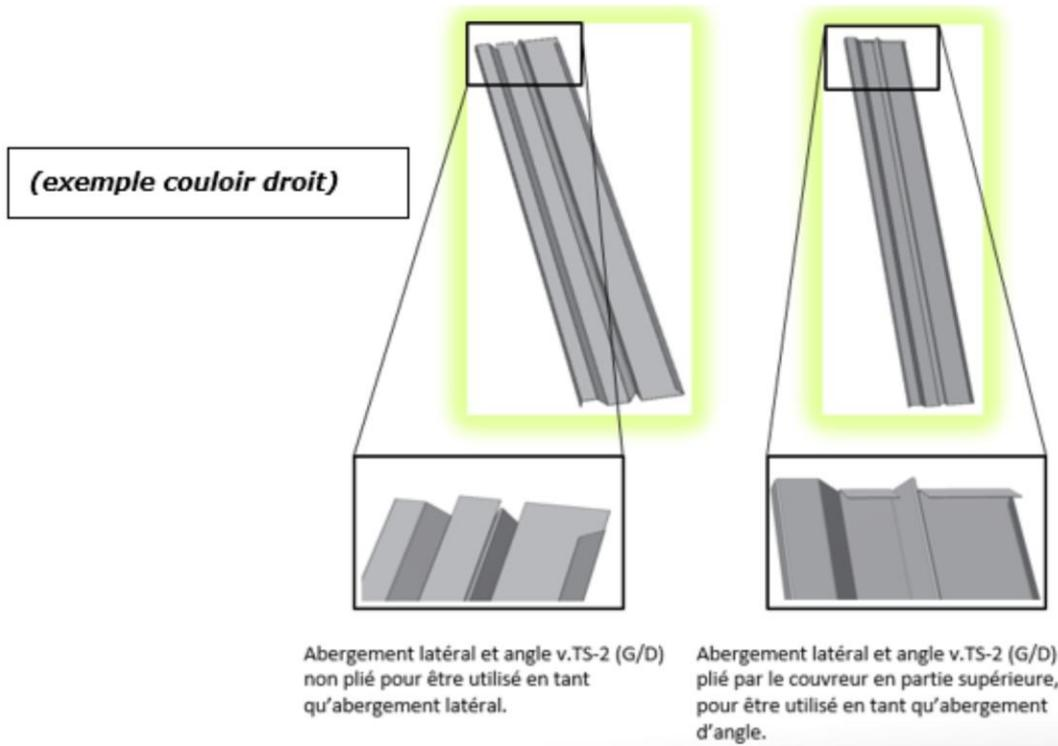
**Figure 24 – Pose des abergements latéraux (kit TS-2)**
