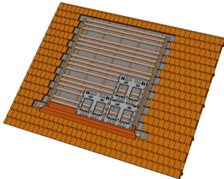
Figure 35 – Mise en œuvre du bas de champ (kit TN-1)
