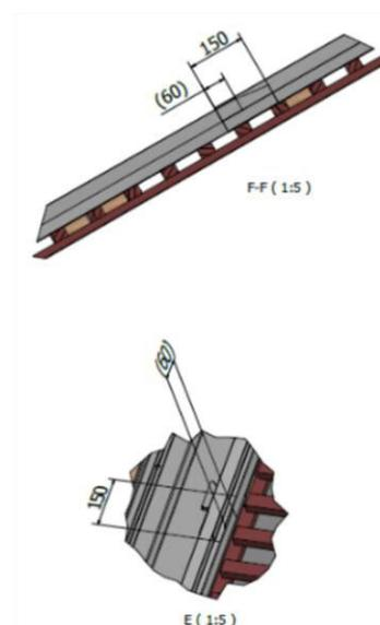
**Figure 31 (suite) – Pose des abergements latéraux et d'angles supérieurs (kit A-2)**
