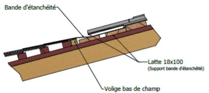
**Figure 29 – Mise en œuvre du bas de champ (kit A-2)**
