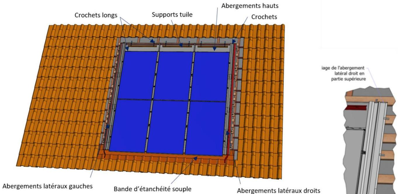
Figure 28 – Éléments du kit TS-2 mis en œuvre
