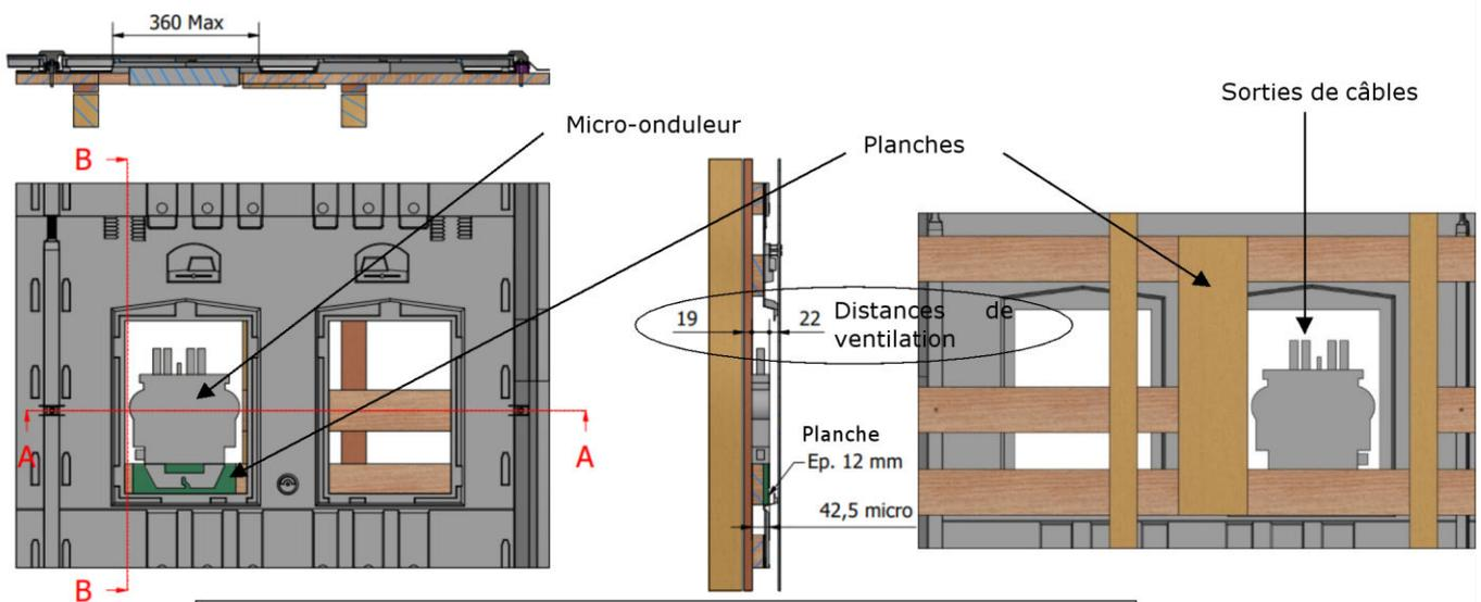
**Exemple d'un micro-onduleur multi-module**
