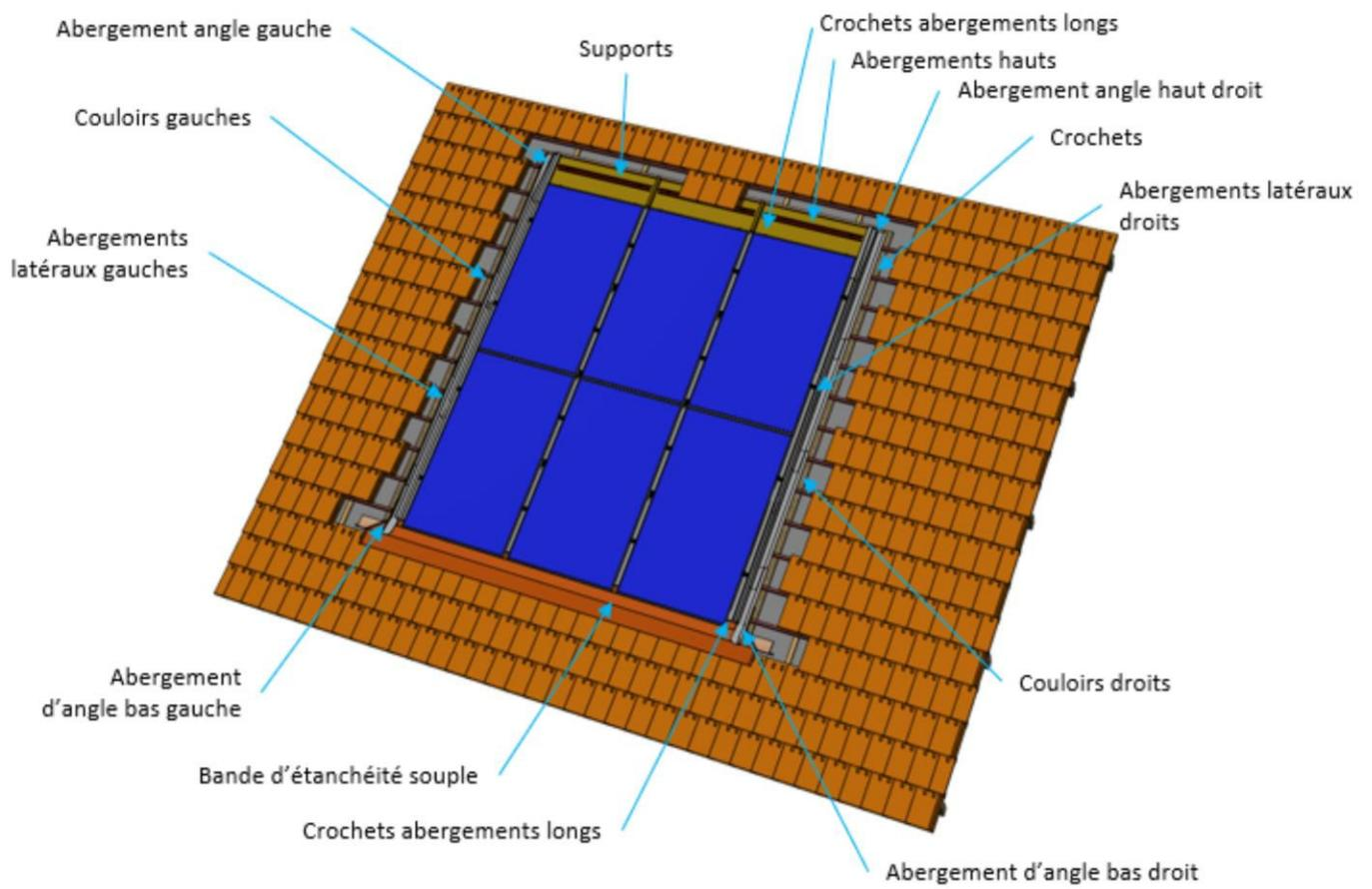
**Figure 39 – Éléments du kit TN-1 mis en œuvre**
