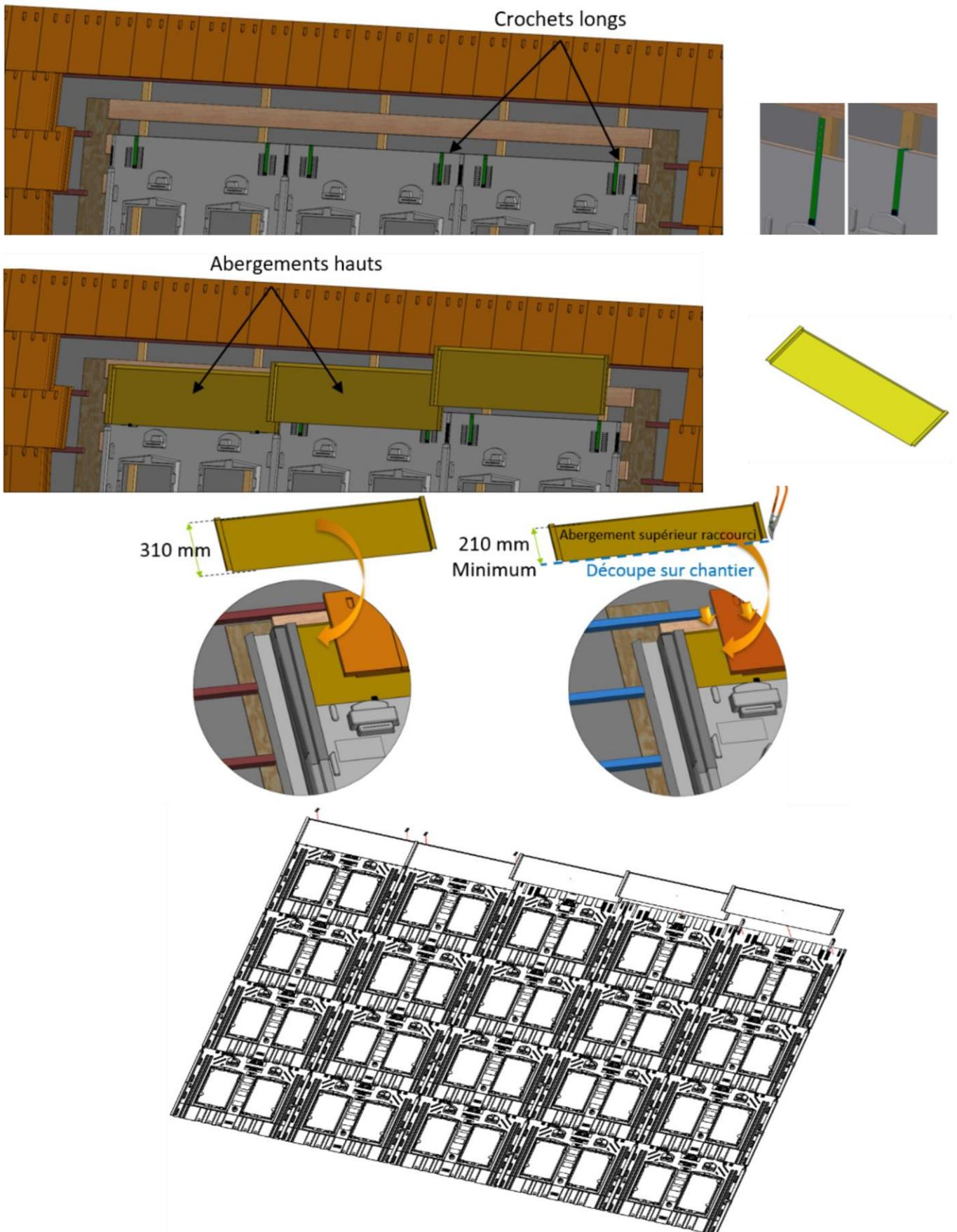
**Figure 36 – Pose des abergements supérieurs (kit TN-1)**
