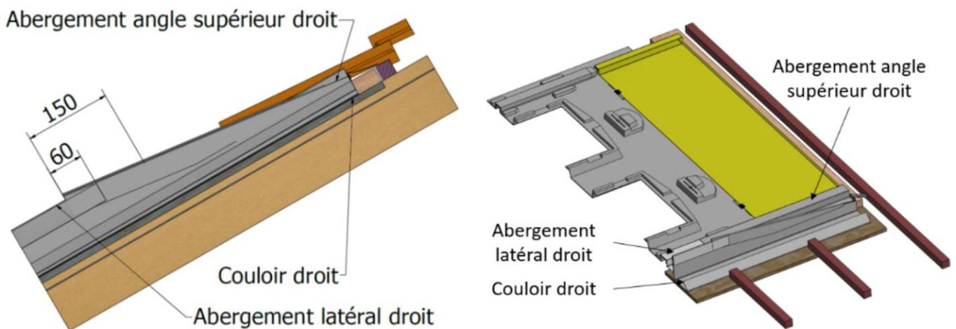
**Figure 37 – Pose des abergements latéraux et d'angles supérieurs (kit TN-1)**
