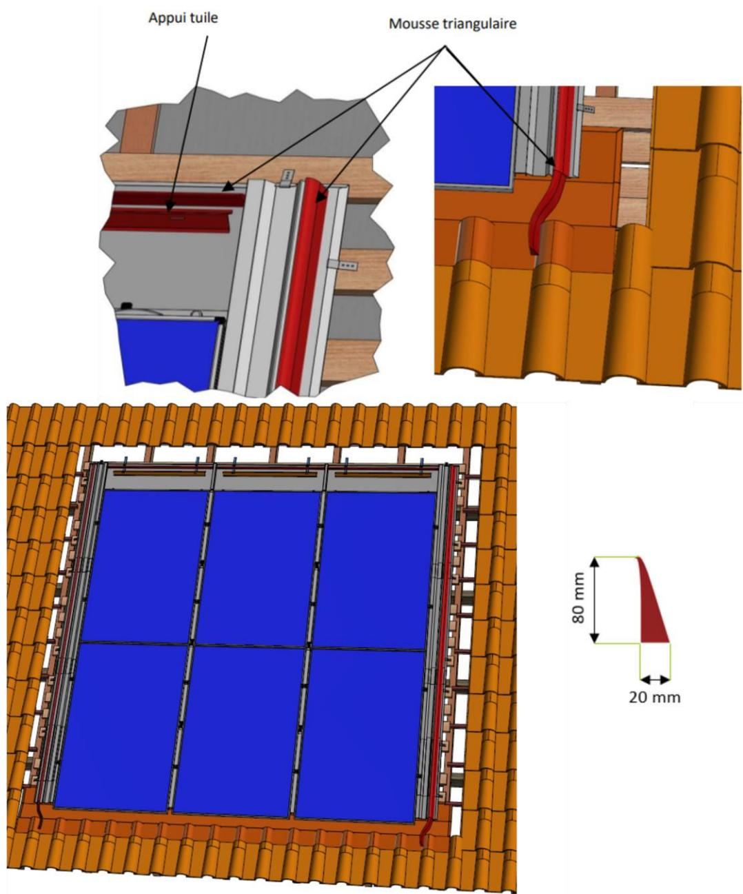
**Figure 26 – Pose de la mousse triangulaire (kit TS-2)**
