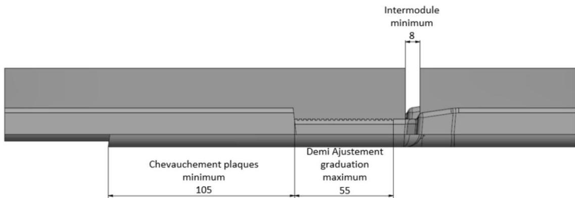
**Figure 21 – Positionnement des modules verticalement et en haut de champ**
