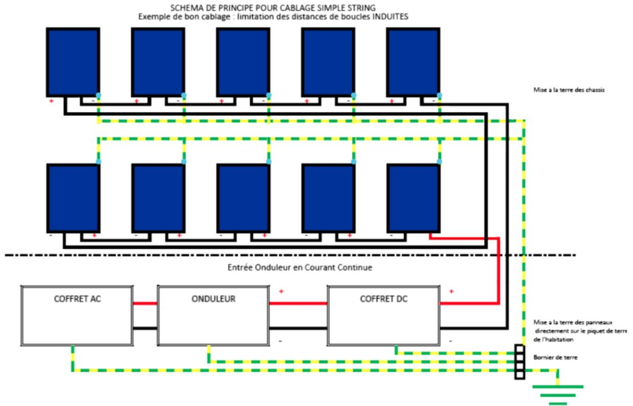
**Figure 13 – Principe de câblage**
