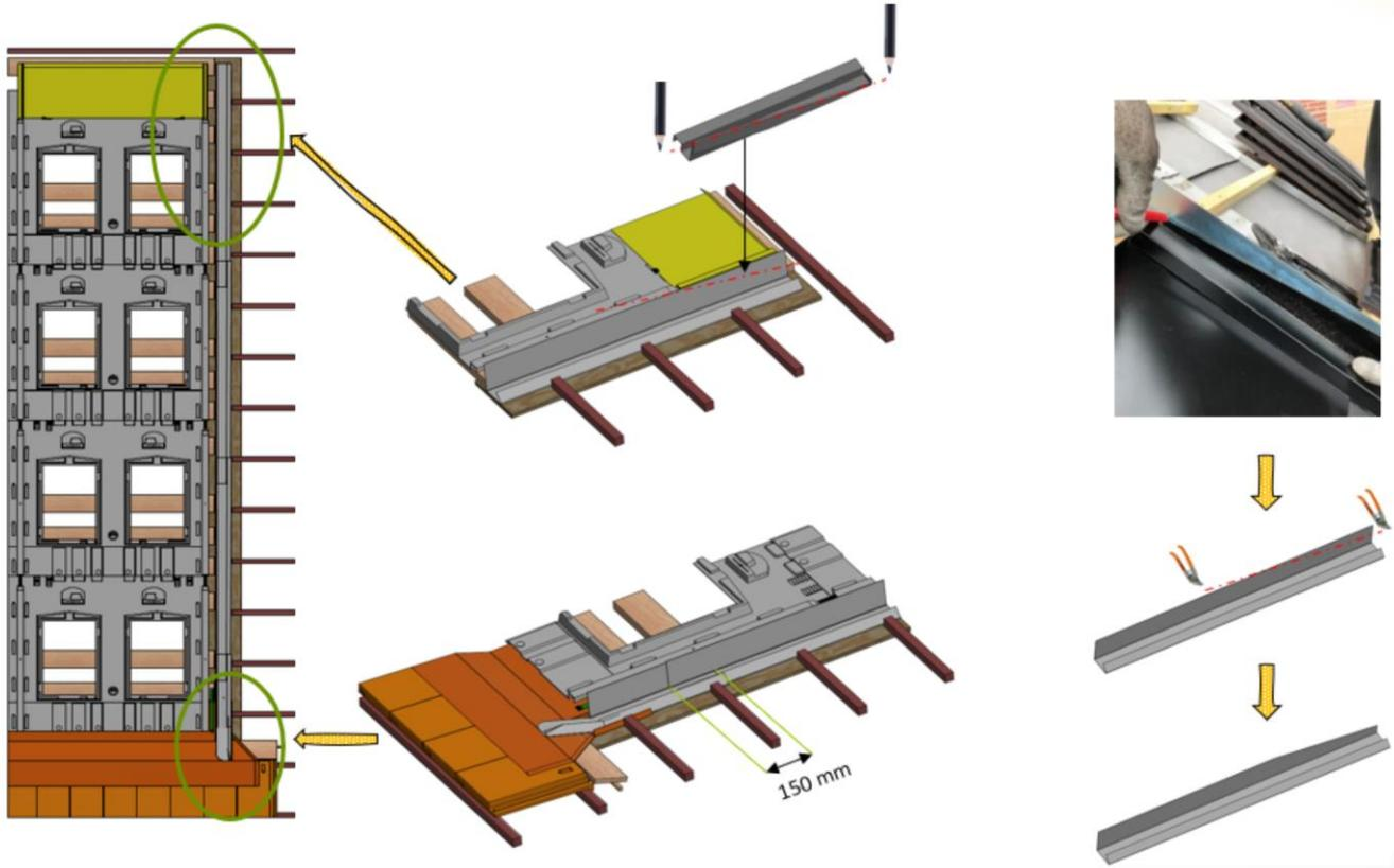
**Figure 37 – Pose des abergements latéraux et d'angles supérieurs (kit TN-1)
