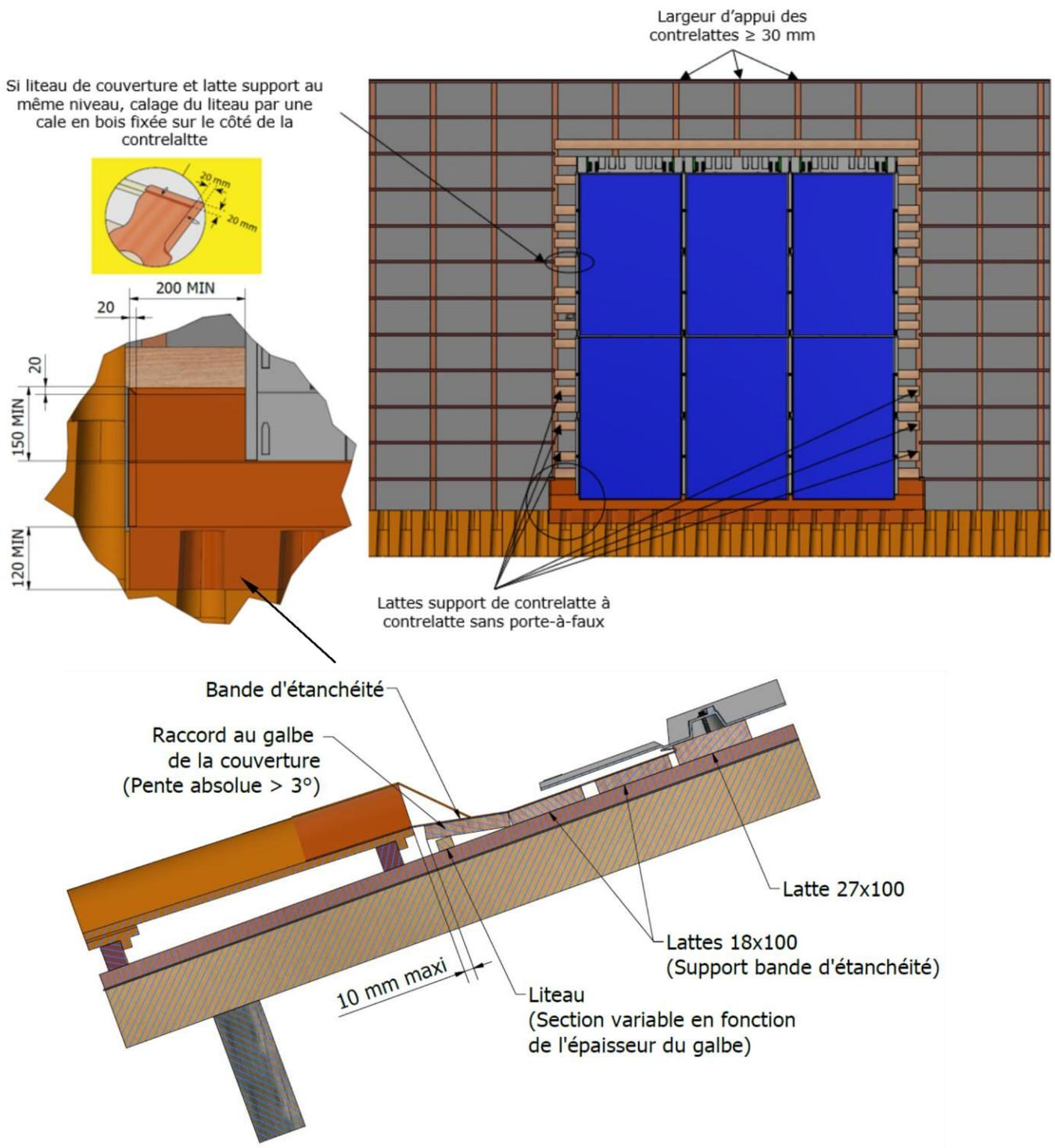
Figure 22 – Mise en œuvre du bas de champ (kit TS-2)
