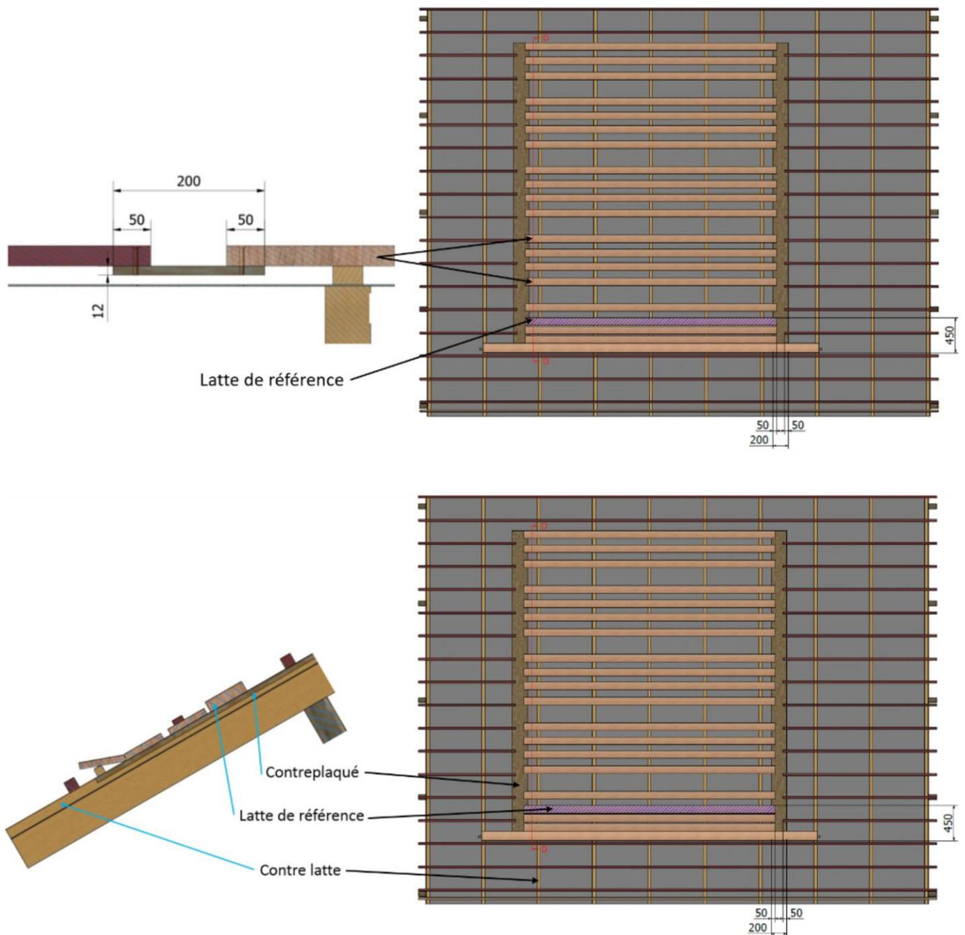
**Figure 34 – Pose de la fonçure (kit TN-1)**
