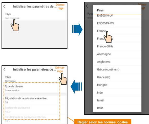
**Fig. 7-4** Paramètre de protection de l'initialisation
