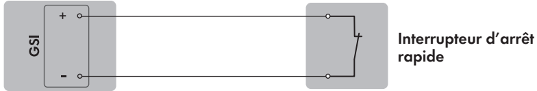
Figure 11 : Raccordement d'un interrupteur d'arrêt rapide à l'entrée numérique GSI du Sunny Boy Smart Energy qui doit être configuré comme System Manager
