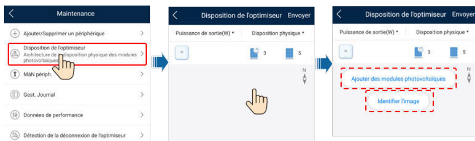
Figure 7-7 Disposition physique des modules PV
