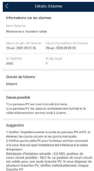
Figure E-1 Détails d'alarme
