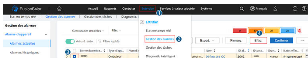
Figure 7-6 Effacement des alarmes
