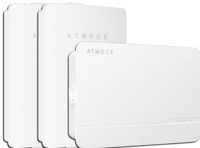
Le combineur M-Combiner est un dispositif de gestion de l'énergie qui intègre une passerelle, un relais d'interface réseau, des capteurs de courant et des disjoncteurs, qui interagit avec les micro-onduleurs, les batteries et les charges et qui permet la connexion réseau.
