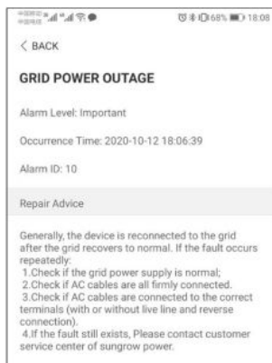
Figure 7-9 Informations détaillées sur l'alarme de défaut
