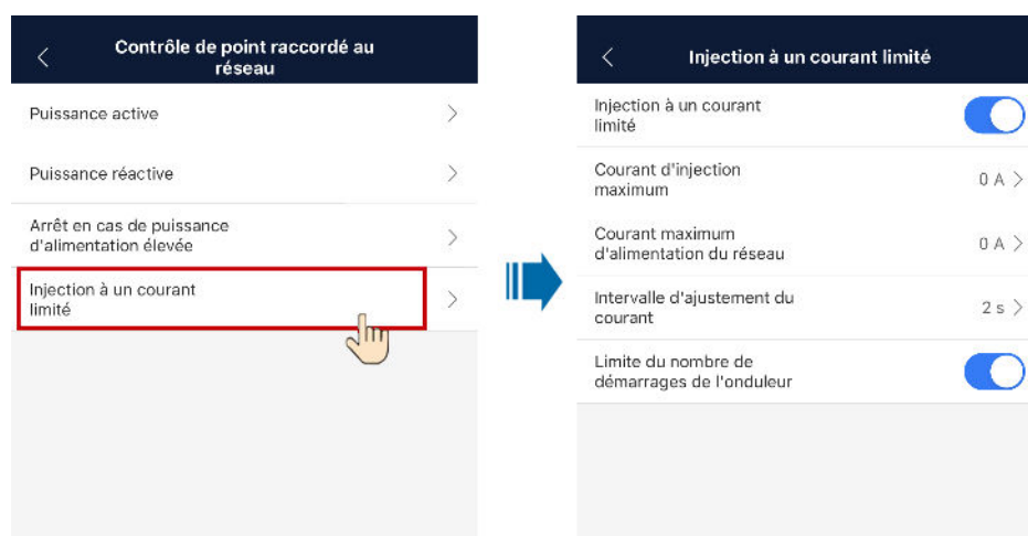
Figure 7-8 Injection à un courant limité
