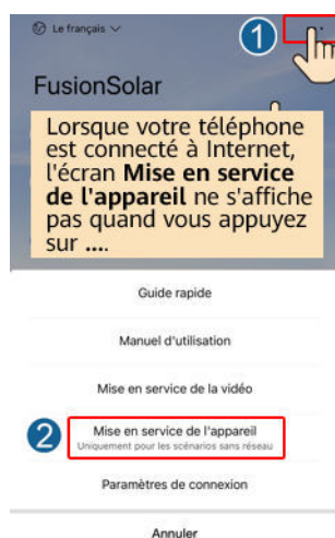
Figure B-1 Méthode 1 : avant la connexion (non connecté à Internet)
