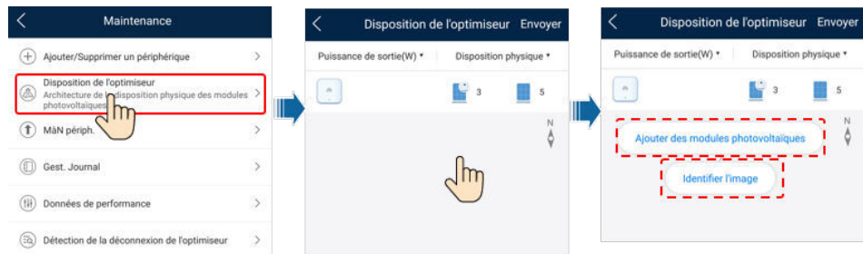
Figure 7-7 Disposition physique des modules PV
