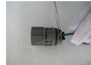
▲ Figure 4.16 Connexion des câbles à la borne
