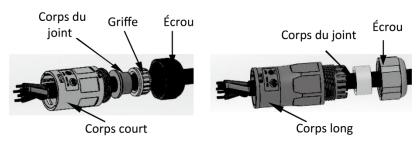
• Fils à sertir, couple de torsion de la vis 0,8+/-0,1N-m.
