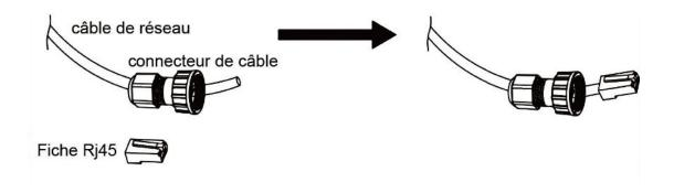
Étape 4: Insérez le connecteur du câble dans le port COM situé au bas de l'onduleur et vissez-le fermement. Insérez ensuite l'autre côté du câble réseau dans le PC ou un autre appareil.
