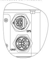
• Retirez le connecteur RESEAU: Poussez la baïonnette hors de la fente à l'aide d'un petit tournevis ou de l'outil de déverrouillage et tirez-la, ou dévissez la douille filetée, puis tirez-la.
