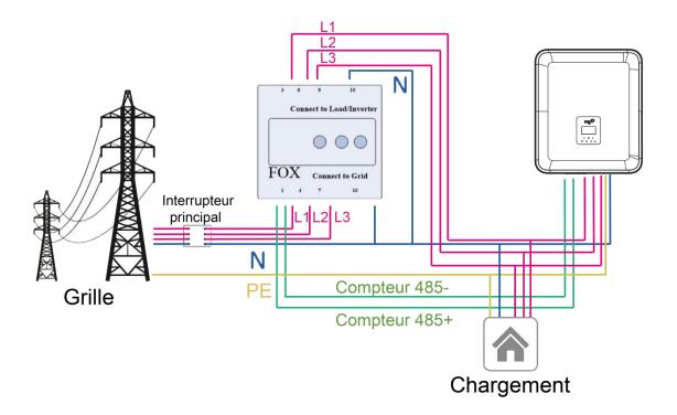
L'onduleur peut également fournir l'utilisation de deux compteurs, en utilisant le deuxième compteur pour lire la puissance générée par une autre machine, où l'adresse du deuxième compteur est 2. Lorsque vous utilisez la fonction de deuxième compteur, vous devez activer la fonction de deuxième compteur.
