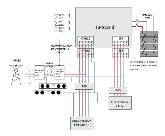
Ce schéma est un exemple d'application dans laquelle le neutre est séparé du PE dans le boîtier de distribution.
