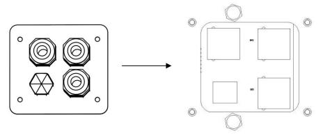
Étape 2: Préparez un câble réseau standard et un connecteur de câble, puis insérez le câble réseau dans le connecteur de câble.
