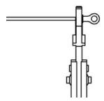
Utilisez la pince à sertir pour enfoncer le câble de masse dans la borne de masse, vissez la vis de masse avec le tournevis comme indiqué ci-dessous:
