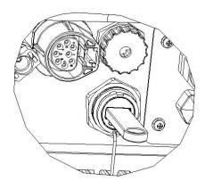
Étape 3: L'écran LCD affiche le menu de sélection. Ensuite, appuyez sur le haut et le bas pour sélectionner celui que vous voulez mettre à niveau et appuyez sur «OK» pour confirmer la mise à niveau. Étape 4: Une fois la mise à niveau terminée, retirez le U-disk. Vissez le couvercle étanche.
